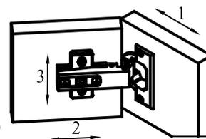
1. Регулирование смещения двери по ширине: ослабьте крепежный винт, регулировочный винт поверните вправо (зазор больше) либо влево (зазор меньше), после чего снова затяните крепежный винт.
